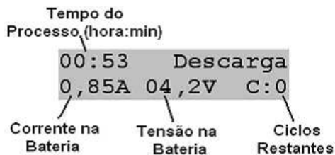
Fig. 8. Mensagem durante carga de bateria.
